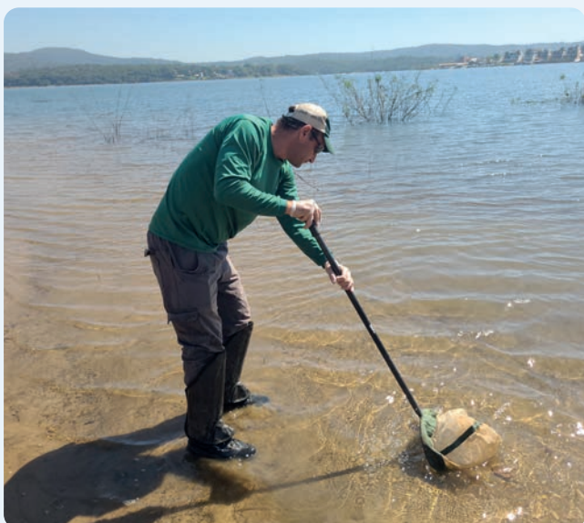
Coleta de macroinvertebrados bentônicos com rede em formato D
